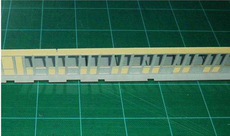
Die Querwände des Admin – und Gepäckabteil werden vormontiert. Die montierte Quer Abteilwände werden ebenfalls in die Schlitten geklebt in die Bodenplatte.
